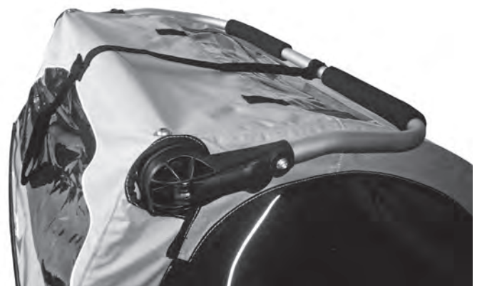
Abbildung 27: Korrekt gesicherter Sicherungsriemen im Fahrbetrieb
