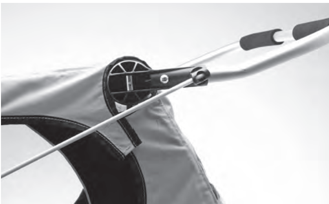
Abbildung 33: Schiebetrieb mit waagrecht nach vorn ausgerichteter Sicherheitsfahne
