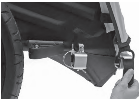
Abbildung 17: Korrekt eingehängte D-Ösen
