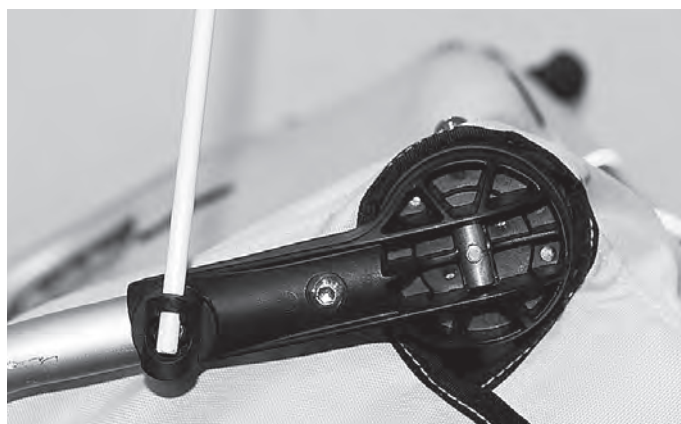
Abbildung 32: Sicherheitsfahne in die linke Aufnahme stecken
