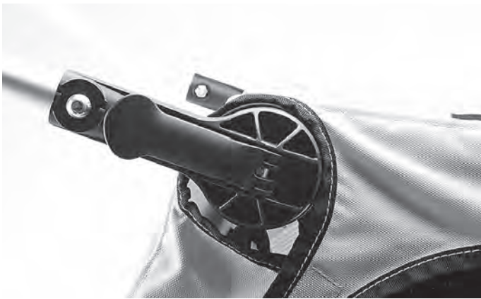
Abbildung 26: Schnellspannhebel, korrekt geschlossen und gesichert
