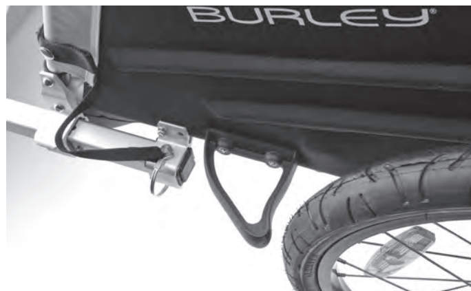
Abbildung 6: Korrekt montierter Radabweiser
