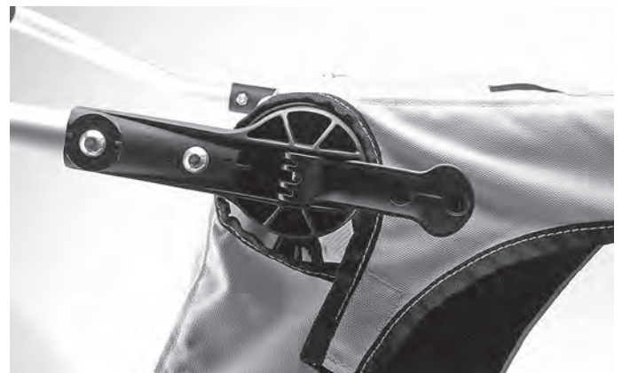
Abbildung 25: Bügel zum Anhängerheck ausrichten
