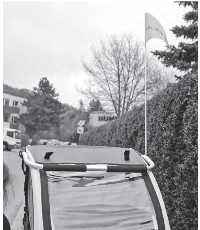
Abbildung 34: Fahrbetrieb mit korrekt ausgerichteter Sicherheitsfahne
